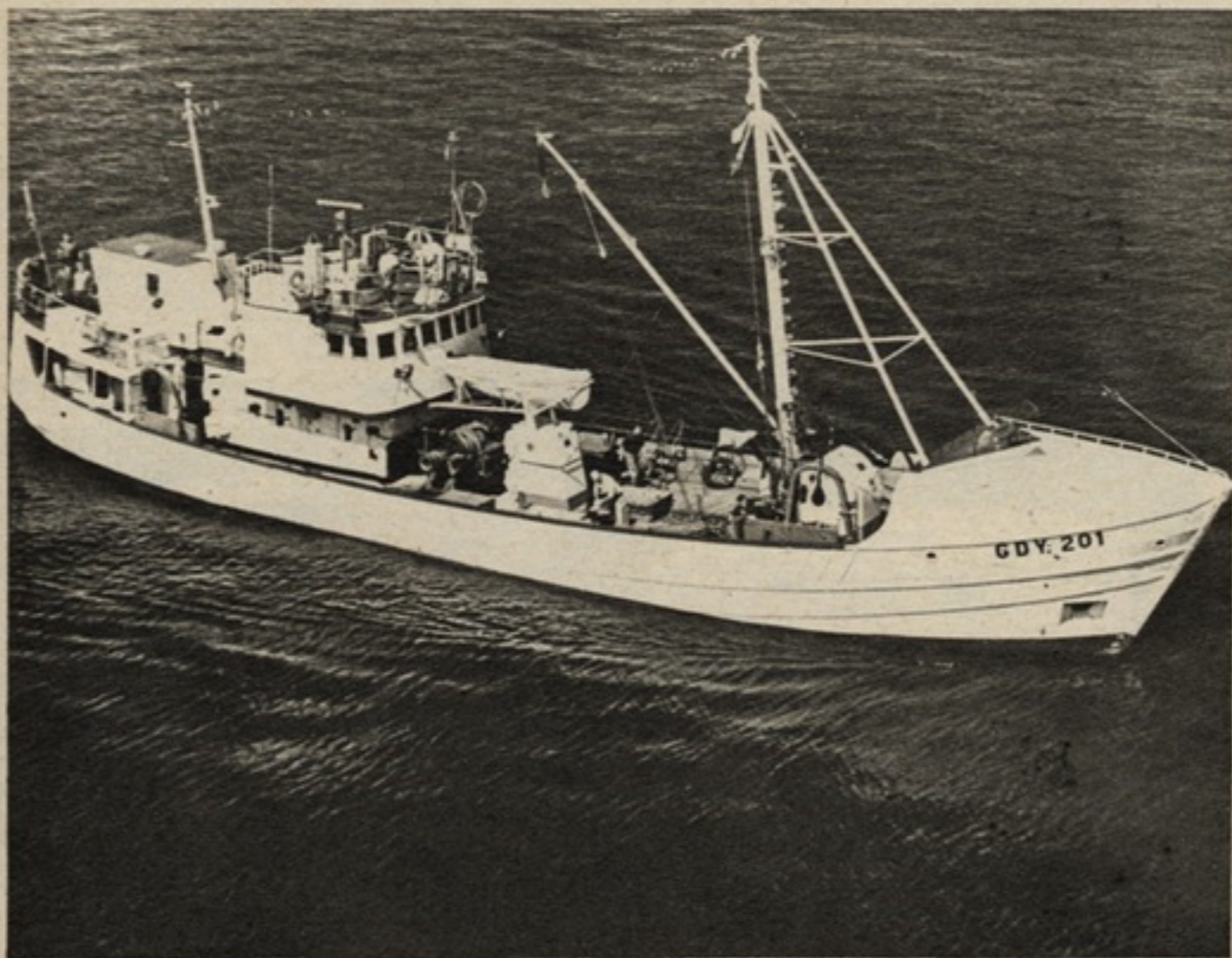
Oryginalną nazwę CZAPLA oraz mało zmienioną sylwetkę zachował statek ratowniczo-rozpoznawczy Polskiego Ratownictwa Okrętowego, przebudowany z seryjnego lugrotrowlera w 1959 r. Wyposażony jest m. in. w echosonde poziomą i aparaturę telewizyjną do poszukiwania wraków. (fot. J. Ukłejewski)
